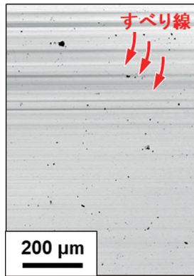
図6 レーザー顕微鏡(Keyence、VK-X100)を用いて得られた、暗室下で変形させた結晶の表面観察像。
