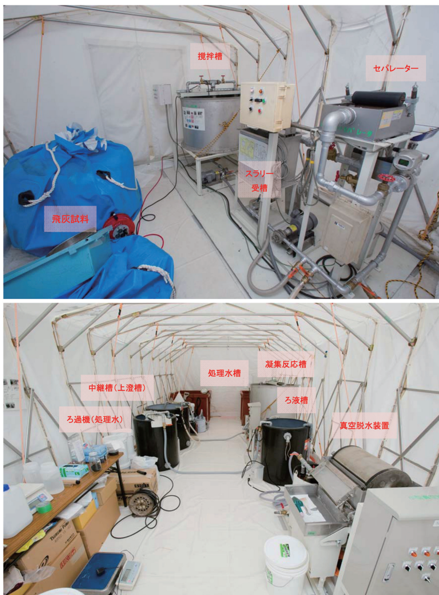
図22 高線量飛灰の取扱い範囲(上)・除染済スラリーの取扱い範囲(下)
