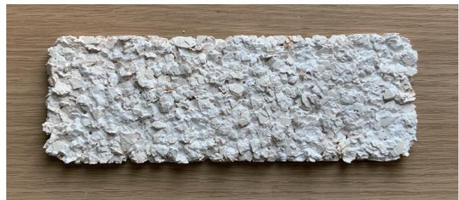
図-2 卵殻 / 石膏混合型の試料板作製の様子(左：板の作製用型、右：卵殻70%混合試料板)
