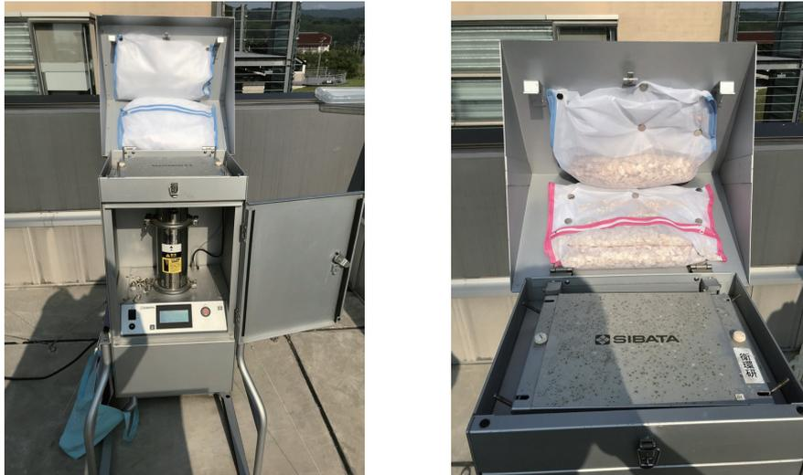
図-1 PM10捕集装置を用いた卵殻のPM吸着機能の確認試験
