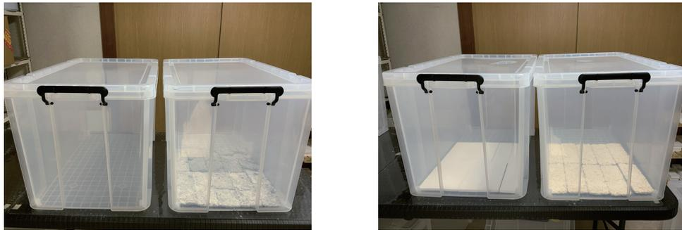
図-5 PM2.5吸着試験用のポリプロピレン製容器と測定の様子
