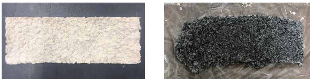
図-6 石膏をベースに作製した試料板(左:卵殻含有率70% 試料板、右:活性炭含有率70% 試料板)
