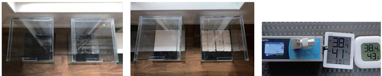
図-3 PM2.5吸着試験用ガラス製容器(左からblank、活性炭含有率70% 試料板、純粋な石膏板、卵殻含有率70% 試料板)とPM2.5用デジタル粉じん計、温湿度計
