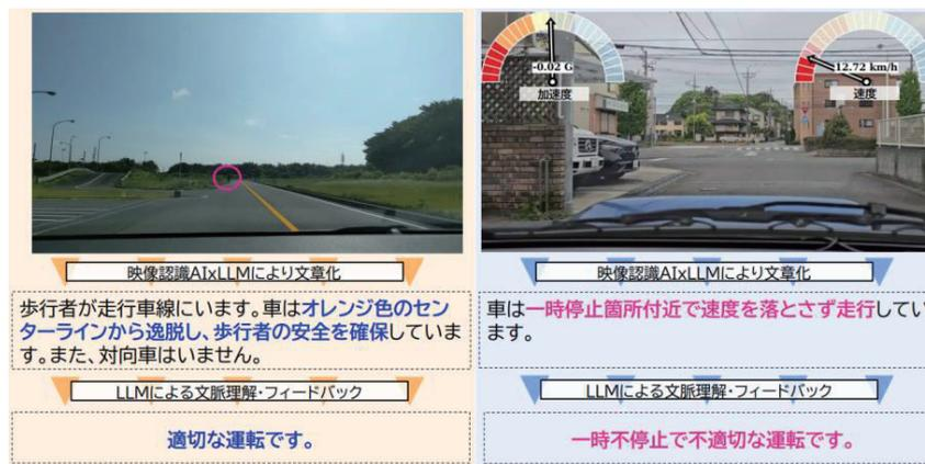
図8：映像認識 AI と LLM により出力された運転操作およびフィードバック文章の例
